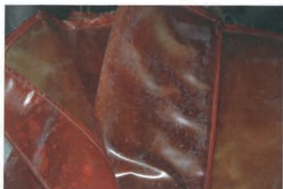
Figur 35. Detalj av regnrocken i bilden till höger, med kristaller av mjukgöraren DOP (dioktylfthalat).
