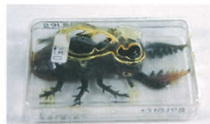
Figur 49. Fiskedrag av PVC som förvarats i en ask av plexiglas. Plasterna har reagerat med varandra och limmats ihop. Nordiska museet (Inv. nr NM 291.150). Foto: Kerstin Jonsson.
