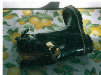
Figur 38. Grön stövel från Korea, inköpt år 2002 av projektledaren. Skaftet är tillverkat i tre skikt av svåridentifierade konstgummin. Hela stöveln blev snart hård och styv, och stora bitar faller bort vid beröring.
